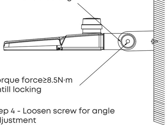
Torque force  $\geq 8.5\text{N}\cdot\text{m}$  untill locking
